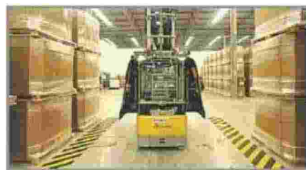
A Frompet adquiriu oito robôs. Eles têm autonomia para trabalhar 24 horas por dia e carregam sozinho suas baterias. Possuem sensor de presença, o que evita acidentes.
